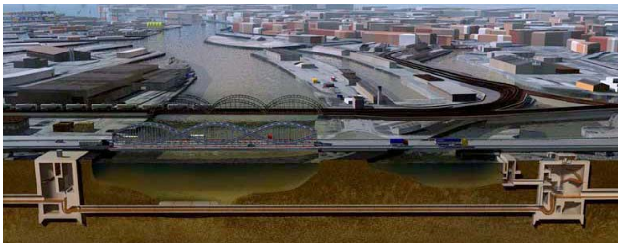
Die Adern der Stadt Der Elbdüker Nord unter der Elbe
